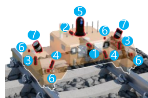
Asignación de sensores (12 cámaras y 2 radares)
